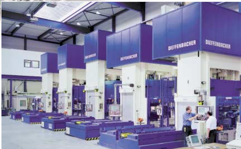
Vollautomatisierte Pressenstraße zur Herstellung von Spülen
