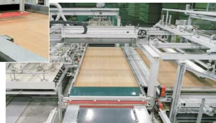
Vollautomatisches Kombinationssystem für Gegenzug, Dekorpapier, Overlay und Rohplattenübergabe
