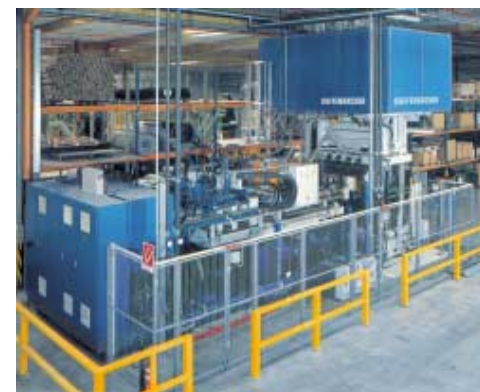
Säulenpresse, 10.000 kN, mit zwei Spritzeinheiten und Koordinatentisch
