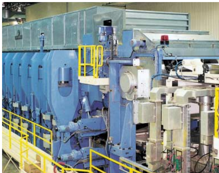
Kontinuierliche CPS-Presse, 40 m lang, mit Mikrowellenvorheizung
