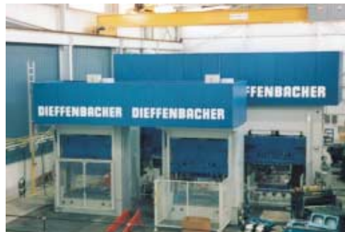
Fertigungslinie zur Herstellung von Doppelbeckenspülen
