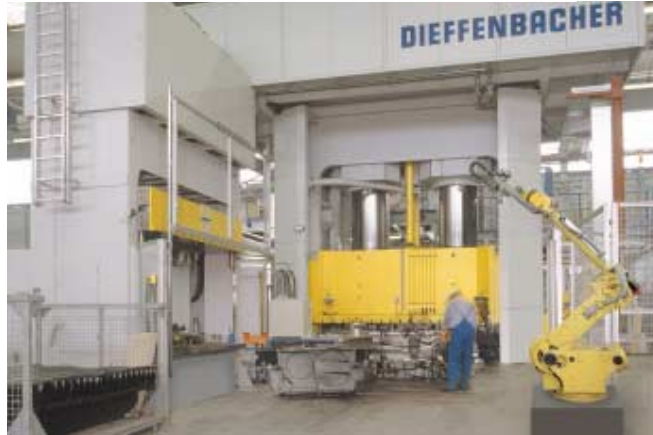
Montage der LFT-D-Anlage im Werk des Kunden
