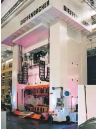
Dreifach wirkende Tryout-Pressen, Gesamtpresskraft: 20.000 kN
