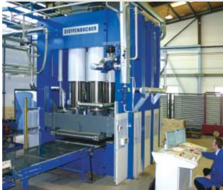
Contisimulationspresse im Format 600 x 800 mm ▶
