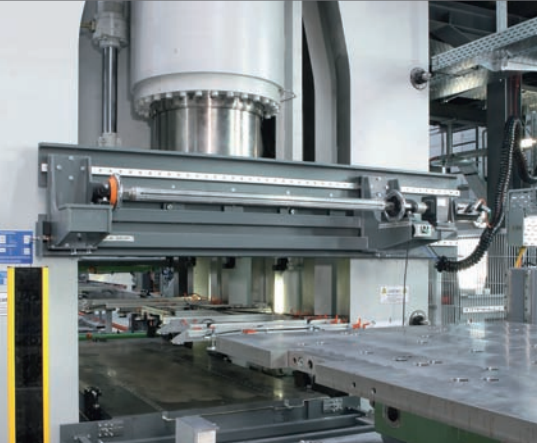
Automationsinheit Werkzeugwechsel der Prägepresse
